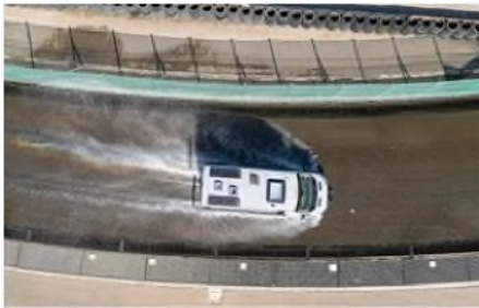
Der Aquaplaning-Test (quer) prüft die Sicherheitsreserven bei plötzlichen Pfützen in Kurven.
