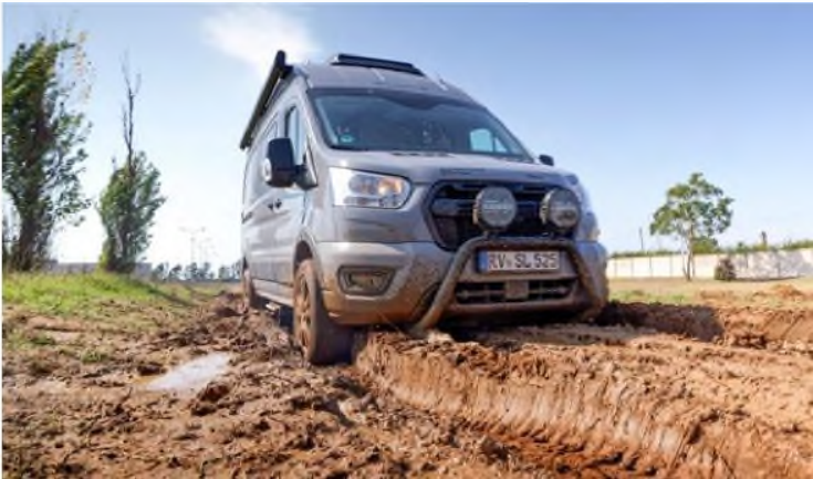
Durchgewühlt: Allein die Vorbereitung und konstante Bewässerung der homogen durchfeuchteten Erdfahrbahn dauerte mehrere Wochen.
