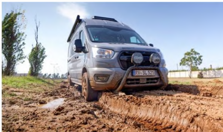
Durchgewühlt: Allein die Vorbereitung und konstante Bewässerung der homogen durchfeuchteten Erdfahrbahn dauerte mehrere Wochen.
