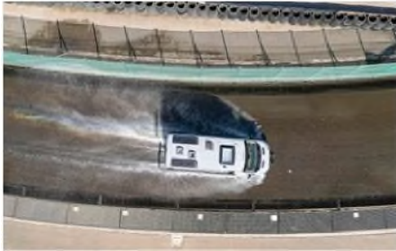
Der Aquaplaning-Test (quer) prüft die Sicherheitsreserven bei plötzlichen Pflügen in Kurven.
