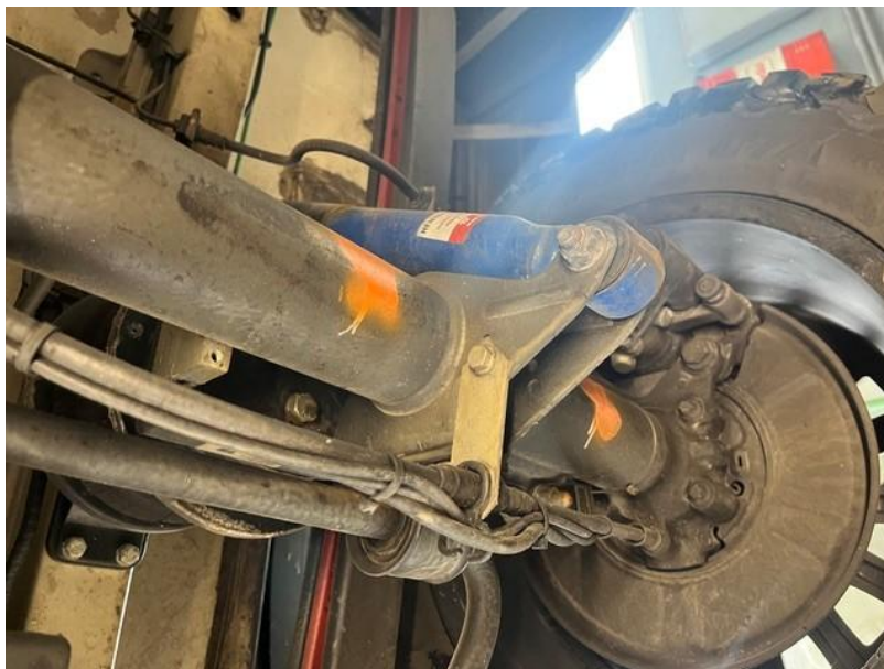
Bild4: Wagenheber Aufnahmepunkte auf der Hinterachse. ideal für Wagenheber mit "Maul"
