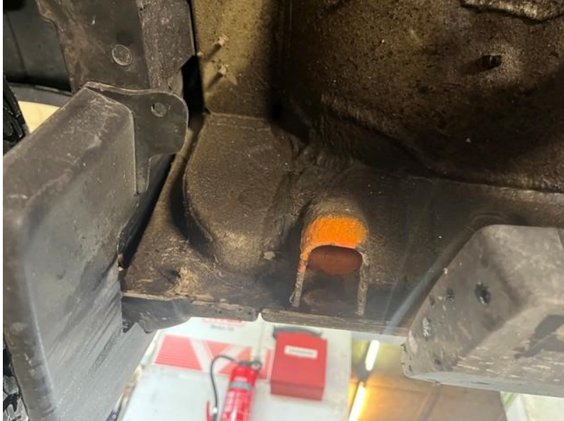
Bild3: Wagenheber-Aufnahmepunkte direkt hinter Vorderrädern links und rechts
