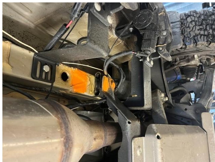
Bild2: Wagenheber Aufnahmepunkt vorne rechts
